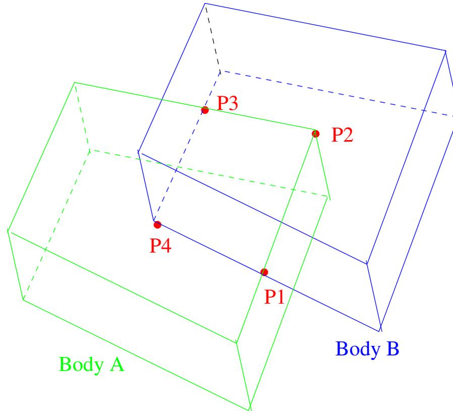
Die beiden Körper berühren sich in einer Kontaktfläche. Der Kontakt wird mit 4 Punkten beschrieben.
